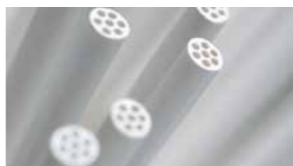
过滤纤维横截面：包含七根毛细管的蜂巢结构能稳定纤维，以防止产生可被病原体穿透的微小裂缝。
