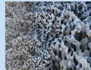
水穿透滤膜表面后，就可以通过多孔塑料流到外面。
