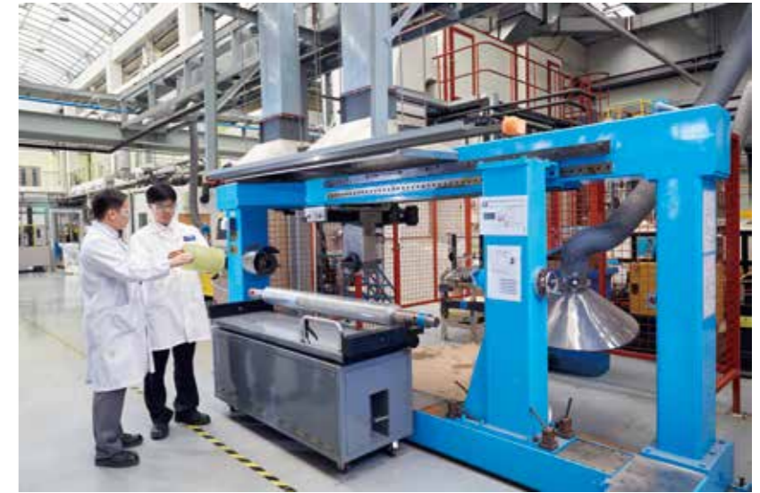
这台机器将被用于复合材料缠绕工艺的测试。
